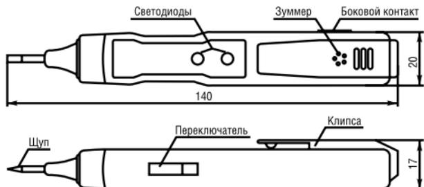
– положение «L» – режим бесконтактной работы, низкая чувствительность: горит зеленый светодиод и используется зуммер. Применяется для бесконтактного определения наличия напряжения, электромагнитных полей и т. п.;
