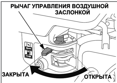
Рис. 9 Воздушная заслонка закрыта
