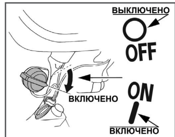
Рис. 12 Выключатель зажигания в положении «Включено»
