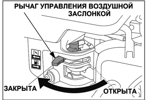
Рис. 10 Воздушная заслонка закрыта
