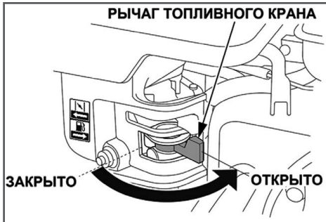
Рис. 9 Топливный кран карбюратора
