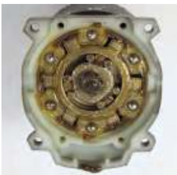
Муфта автоматической блокировки патрона, на три пары блокирующих роликов, внешняя часть достаточно толстая, чтобы выдержать высокие нагрузки. Отлично видна солидная толщина внешней стенки
