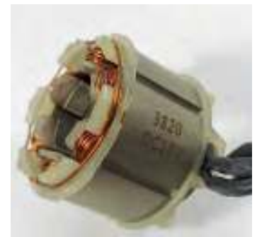
Статор имеет шесть катушек управления с маркировкой 3820 DC18V
