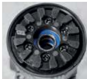
Муфта фиксации дополнительной оснастки и передний опорный подшипник главного вала, он такой же, как и задний ZXHY 6800RS
