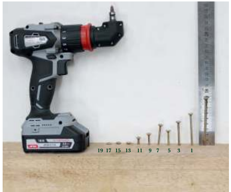
Работа муфты ограничения крутящего момента проверялась при помощи традиционной «лесенки» и на разных насадках
