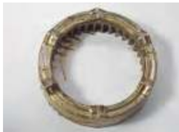
Коронная шестерня, она же муфта ограничения крутящего момента
