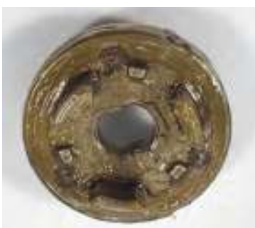
Обратная сторона водила, видны три прилива для снятия блокировки с роликов и передачи им крутящего момента
