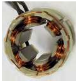
Статор имеет шесть катушек управления с маркировкой 3820 DC18V
