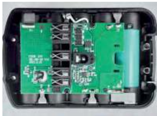
Архитектура платы для пяти элементов. Аккумулятор может заряжаться двояко через разные контакты. Внутри установлены элементы QIXIN ICR18650-2000 mAh. Надёжная и аккуратная точечная сварка элементов на четыре точки
