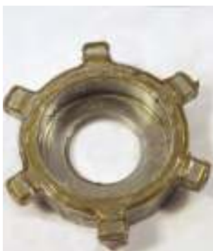
Муфта автоматической блокировки патрона, на три пары блокирующих роликов, внешняя часть достаточно толстая, чтобы выдержать высокие нагрузки. Отлично видна солидная толщина внешней стенки
