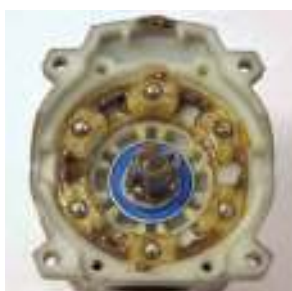
Вторичный или главный вал, на который с обратной стороны крепится патрон. Задний опорный подшипник ZXHY 6800RS главного вала
