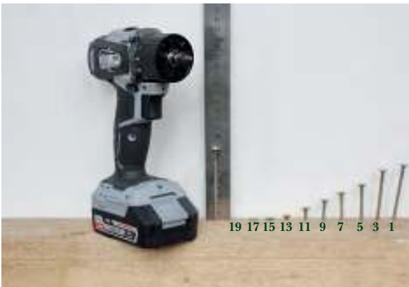
На одном заряде 2,0 Ач аккумуляторной батареи ИНТЕРСКОЛ ДА-13/18ВК КОМБИ вкрутил в сосновый брус красивую цифру чёрных саморезов 4,2×75±2 мм – 340 единиц. Отличный результат!!!
