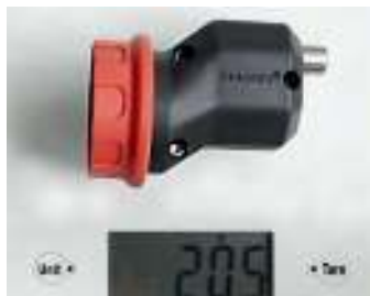
Вес штатных съёмных насадок: насадка для закручивания вплотную к углу – 205 гр., угловая насадка – 210 гр., трёхлапчатый патрон – 246 гр.
