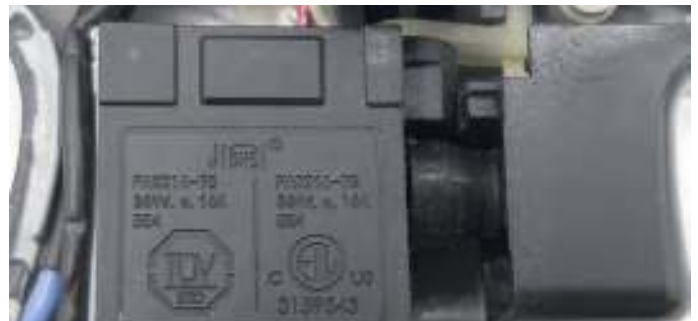
Кнопка выключателя «Пуск» «Jlevel» FA21A-75 с реверсом и плавной регулировкой частоты оборотов, в зависимости от степени нажатия на курок, комбинированная, рассчитана на силу тока 16 А при напряжении 36 В
