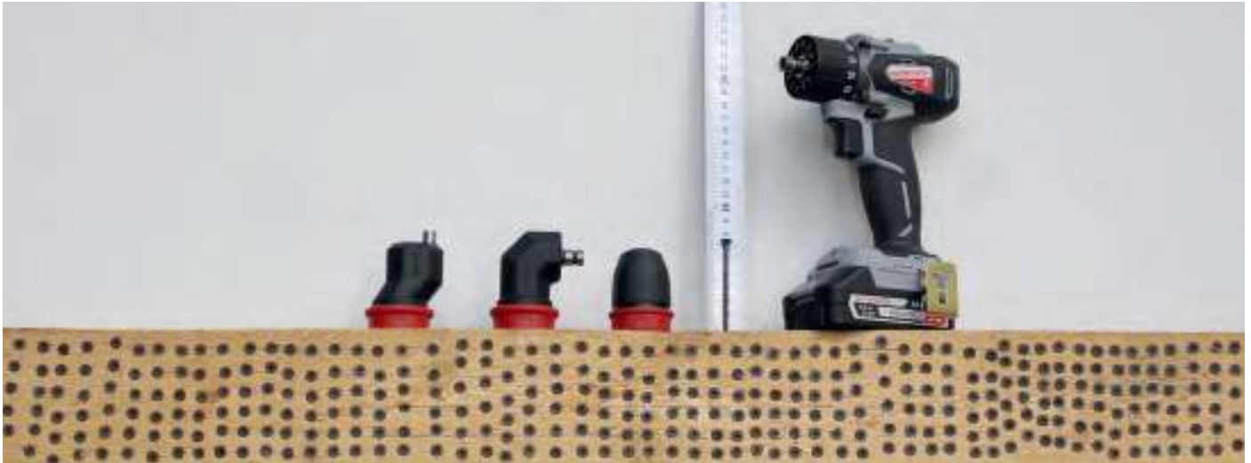
На одном заряде 2,0 Ач аккумуляторной батареи ИНТЕРСКОЛ ДА-13/18ВК КОМБИ вкрутил в сосновый брус красивую цифру чёрных саморезов 4,2×75±2 мм – 340 единиц. Отличный результат!!!
