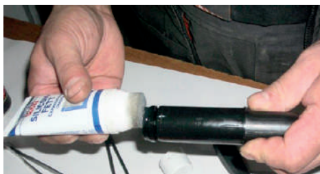
5. Смазываем силиконовой мазью уплотнитель поршня (арт. 6815019).
