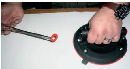
2. Вынимаем стопорное кольцо (арт.6815012), протираем силиконовым спреем.
